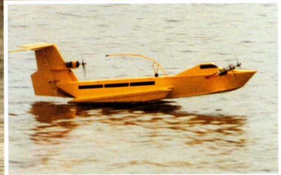
De MK5 in actie op het water, de neus hoog geeft aan dat de trim moet worden bijgesteld.
